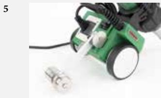
Individualno podešiv odloženi start Minifloor pogonske jedinice omogućava modifikaciju pokretanja u skladu sa individualnim potrebama. Dugi vodič osigurava izvanrednu preciznost duž šava.
