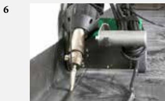
Minimalna udaljenost od zida od 51 mm / 2 inča osigurava bezbedno zavarivanje oko nepropusnih cevi i L-obloga. Zahvaljujući kompaktnoj visini, Minifloor bez problema zavaruje ispod prepreka sa minimalnim klirensom od 295 mm / 12 inča.
